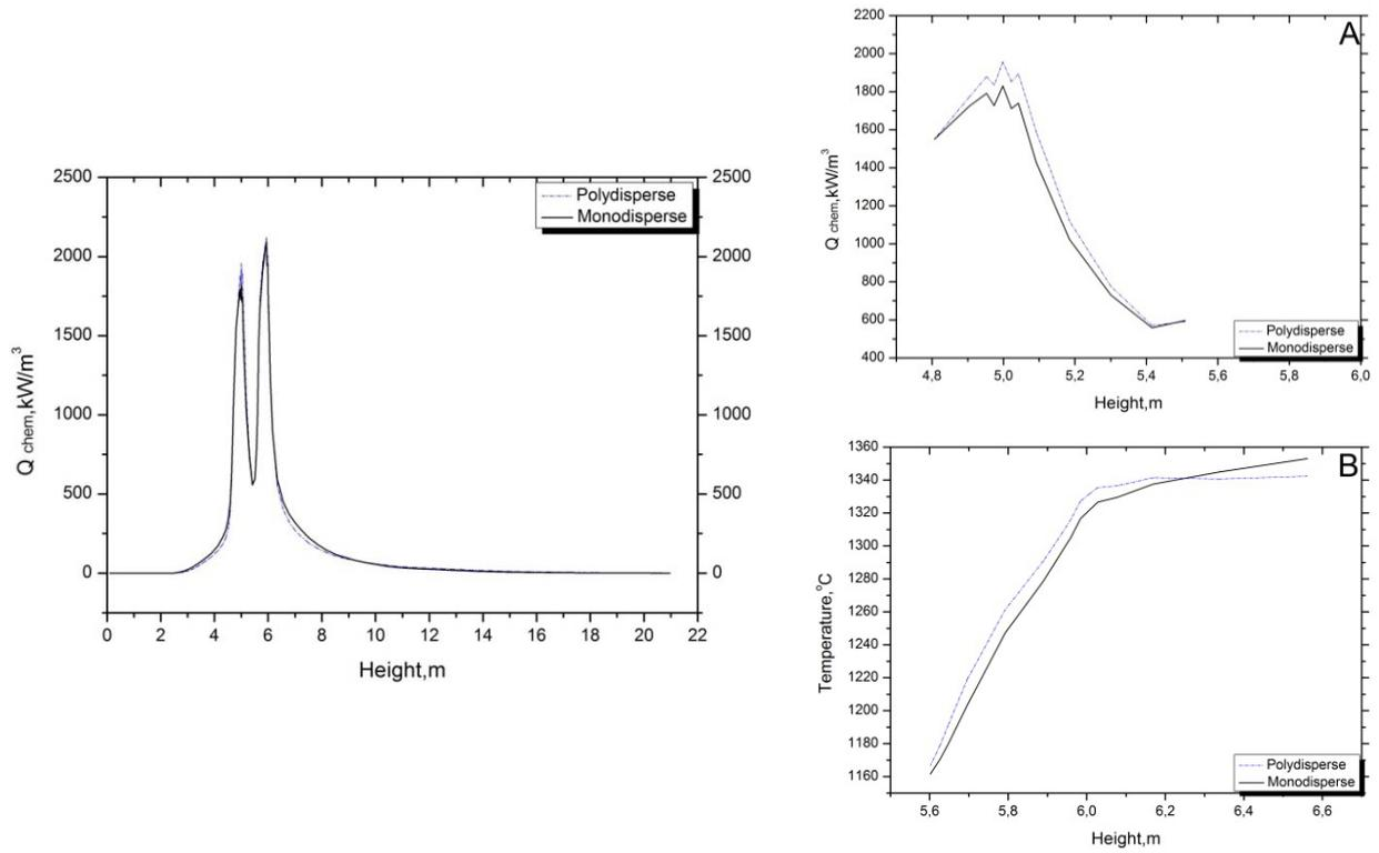
Рисунок 5 – Сравнение средних значений химической энергии  $Q_{chem}$  для поли- и монодисперсного факелов по высоте топочной камеры
