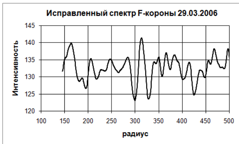
Рисунок 4 – Полностью исправленный Спектр 130-секундной интерферограммы околосолнечной области после устранения двумерного тренда и фильтрации шумов. Полная фаза затмения 29.03.2006. Соответствует 3-му изображению рисунка 3
