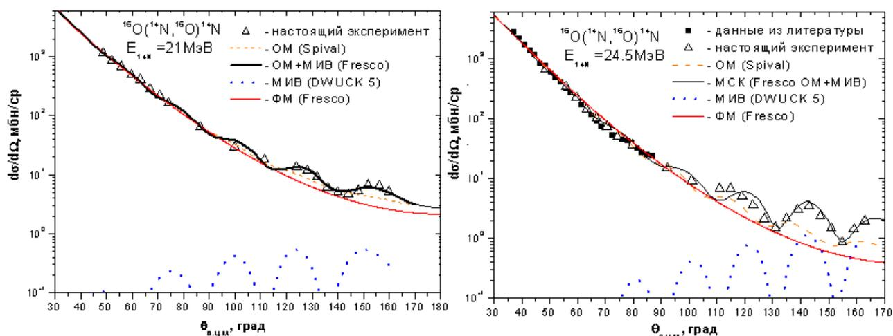
Квадраты и треугольники – экспериментальные данные, сплошная кривая – сечения, рассчитанные по программе FRESKO учет интерференции сечений упругого рассеяния и сечений электронного кластера (OM+МИВ); штриховая кривая – сечения, вычисленные по программе Spival (OM), точечная кривая – сечения, рассчитанные по программе DWUCK5 (МИВ) и сплошная (красная) линия сечения рассчитанные по ФМ
