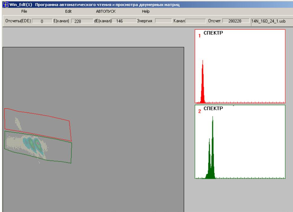
Нижний локус – рассеянные ионы  $^{14}\text{N}$  на ядрах  $^{12}\text{C}$ ,  $^{16}\text{O}$ ,  $^{27}\text{Al}$ , верхний локус – ядра отдачи  $^{16}\text{O}$
