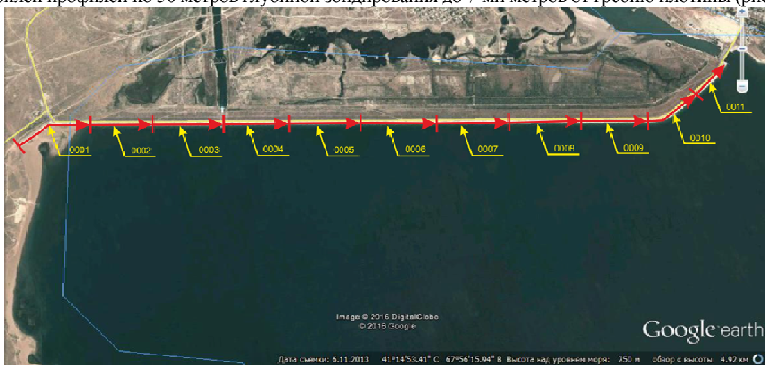
Рисунок 1 – Расположение георадарных профилей на Шардаринском гидрокомплексе.
