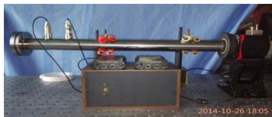
Рисунок 2 – Акустический интерферометр
