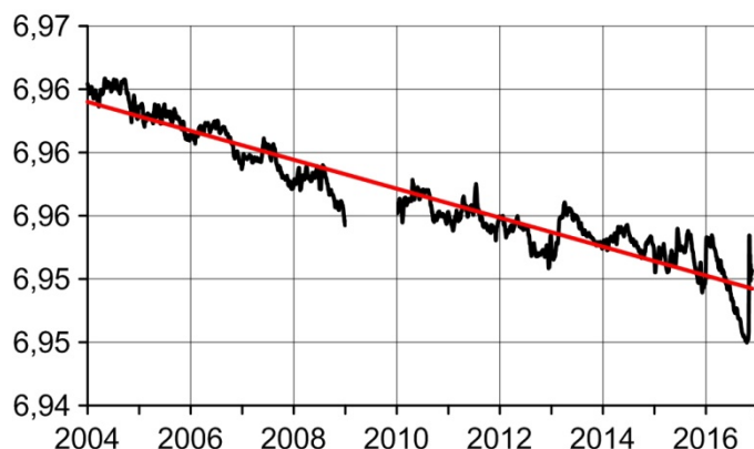
Рисунок 3 - Исходный ряд после применения алгоритма обработки помех осредненный скользящим окном (радиус сглаживания 7 значений) \sigma = 0.001623 , прямая линия – линейный тренд очищенного от помех ряда для вычисления скорости движения GPS станции
